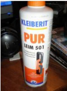
Клейберит полиуретановый клей 501 – влагоотверждающийся, однокомпонентный, на основе полиуретана. Для склеивания с высочайшими показателями прочности. При отверждении увеличивается в объеме (как полиуретановая монтажная пена).
