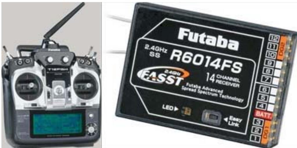
Дополнительный плюс кроется в двусторонней связи, каждая модель в памяти передатчика запоминается на свой приемник. Это не позволяет взлететь с неправильно выбранной моделью.
