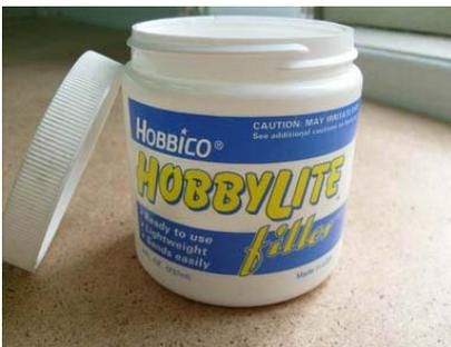
Предназначена для финишной обработки балъзы перед окрашиванием, заполняет неровности и щели, лёгкая, по плотности равна средней балъзе, наносится шпателем. Растворяется водой, растворителем.
