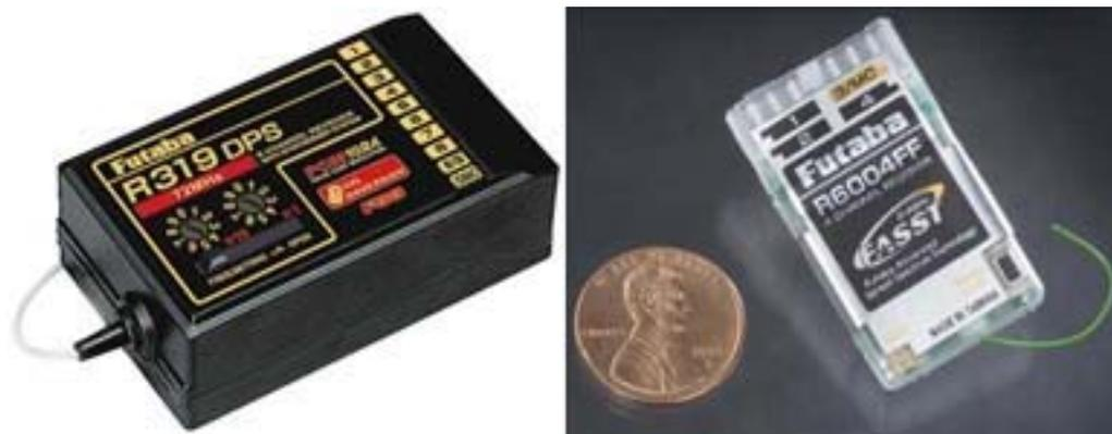
Практически все брендовые производители разработали для своих топовых моделей системы цифрового кодирования РСМ. Это цифровые системы, позволяющие повысить помехозащищенность канала связи за счет сложных алгоритмов перепроверки предварительно оцифрованных пакетов данных. Неприятным обстоятельством является то, что системы РСМ различных производителей не стыкуются между собой.
