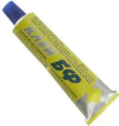
Клеи БФ-2 и БФ-4 склеивают металлы, пластмассы, дерево, стекло, керамику, кожу. Отличаются хорошими электроизоляционными свойствами. Клей БФ-2 используют, когда требуется хорошая влаго- и теплостойкость клеевого шва. Клею БФ-4 отдают предпочтение, если требуется эластичность и морозостойкость соединения. Для достижения высокой прочности соединения склеиваемые поверхности должны быть тщательно подогнаны друг к другу (зазор не более 0,05 мм), очищены от грязи и оксидов, обезжирены аце-
